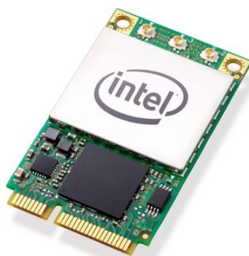
De Wireless-N chip met bovenaan de drie antennepunten
